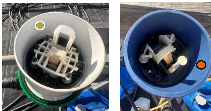
Inspection de l'intérieur des pompes après 6 mois d'utilisation à l'engrais organique liquide © VALENTIN DUQUESNE, ASTREDHOR
