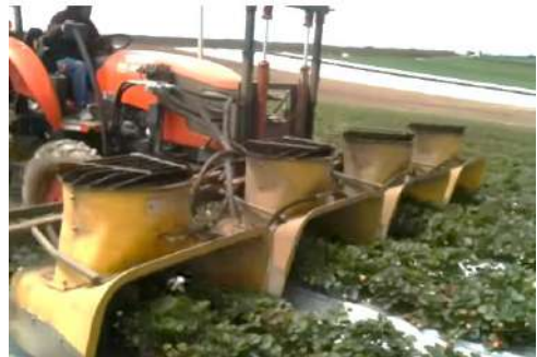
Figure 2: matériel d'aspiration monté sur tracteur en production de fraise en Ontario (source : Youtube)
