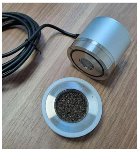
Figure 1 : Sonde de mesure de l'activité de l'eau Rotronic HC2-AW-USB pour mesurer l'humidité relative des lots de graines (ASTREDHOR Seine Manche)
