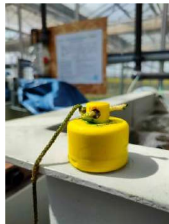
Photo 2 : Sonde ODEON pour le suivi de paramètres physico-chimiques de l'eau des bassins d'élevage.
