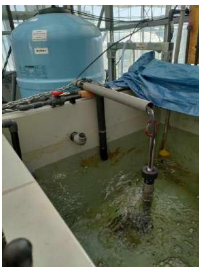
Photo 3 : Sonde multiparamètres VARION w/DIQ/S 284 E XYLEM installée dans la fosse de reprise aquacole (à gauche) et son transmetteur/afficheur pour la visualisation en direct des paramètres suivis (à droite) (ITAVI).
