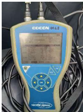
Photo 2 : Sonde ODEON pour le suivi de paramètres physico-chimiques de l'eau des bassins d'élevage.
