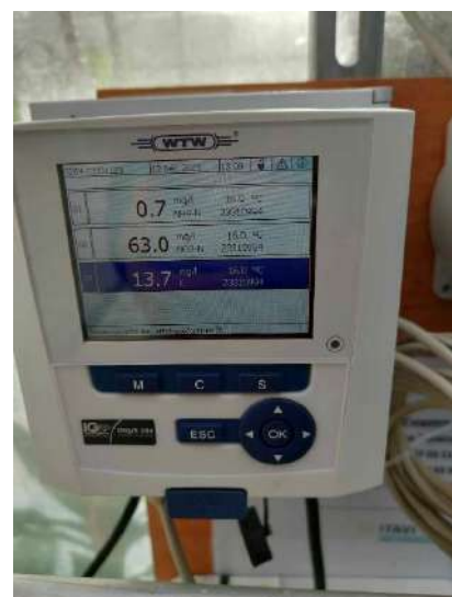
Photo 3 : Sonde multiparamètres VARION w/DIQ/S 284 E XYLEM installée dans la fosse de reprise aquacole (à gauche) et son transmetteur/afficheur pour la visualisation en direct des paramètres suivis (à droite) (ITAVI).
